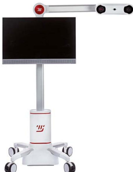
Figura 21. Dispositivo de registro de movimientos mandibulares Mod JAW®.
